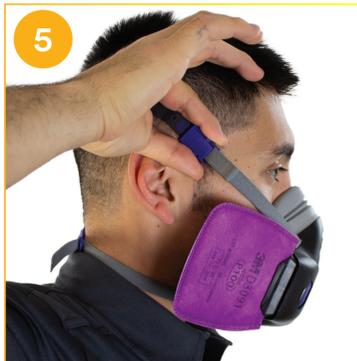
5. Diminuer la tension des sangles du serre-tête en pinçant les ailes de la boucle du serre-tête. Les sangles doivent être serrées, mais pas trop.
